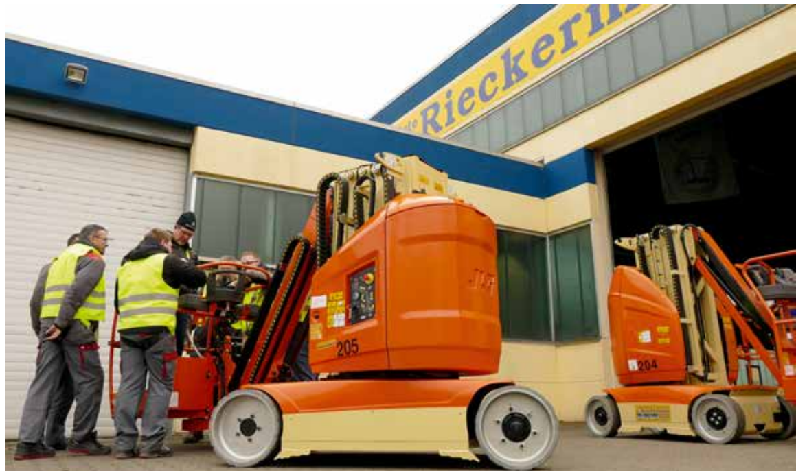
Die Teilnehmer der Schulung bei Rieckermann lernen an der neuen JLG Toucan Vertikalmastbühne.
