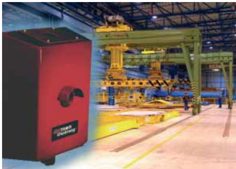
Das Antikollisionssystem sendet in der Betriebsart „Single Reflective“ einen Messstrahl auf einen Reflektor, der beispielsweise am Ende einer Kranbahn oder an festen beziehungsweise beweglichen Hindernissen angebracht ist, und sorgt so für ein sanftes Anhalten des Krans. (Bild: Cattron-Theimeg Europe)
