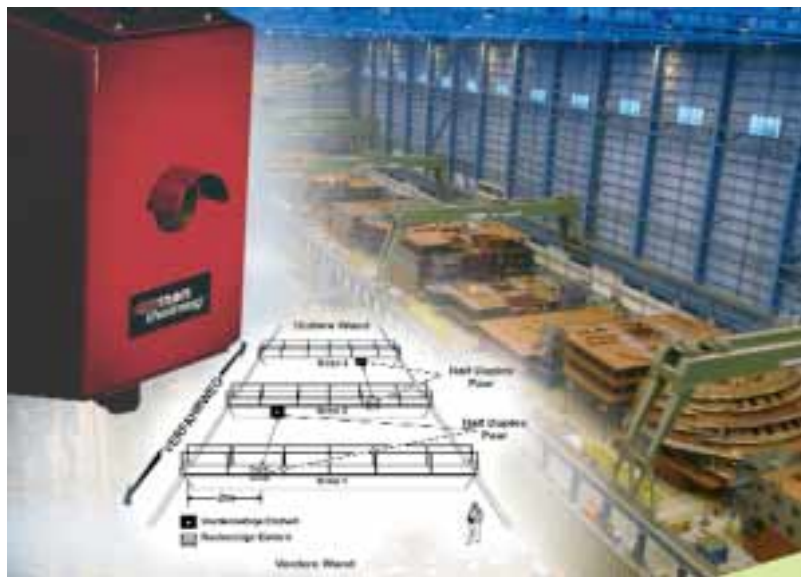
Beim Einsatz mehrerer Krane auf einer Kranbahn empfiehlt sich die Betriebsart „Half Duplex“. Bei dieser Betriebsart kommunizieren je Kranpaar zwei UltraGuard-Geräte miteinander im „Handshake-Verfahren“, wodurch höchste Sicherheit gegen Störungen durch vagabundierende Ultraschallreflektionen erreicht wird. (Bild: Cattron-Theimeg Europe)
