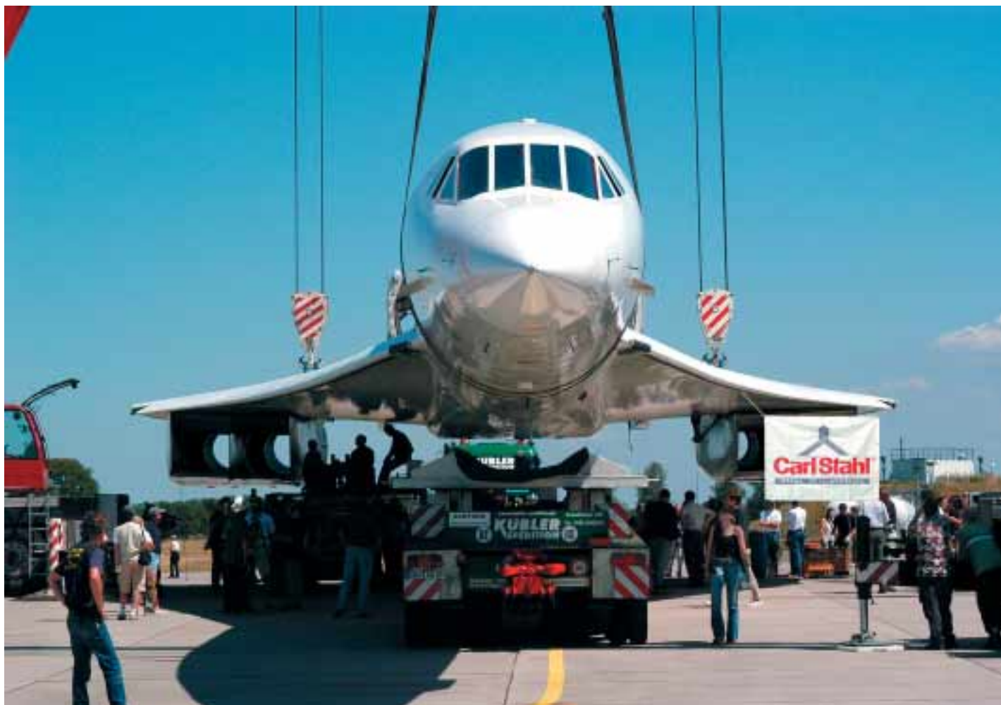
Prominentes Transportgut: Concorde der Air France. Damit beim Kranhub alles Glatt ging, kamen Bandseilhebebänder von Carl Stahl zum Einsatz.
