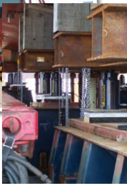
Jeder Block wird zur Helling transportiert und auf mehrrädri- gen Transportvorrichtungen entlang der Helling ausgerichtet.
