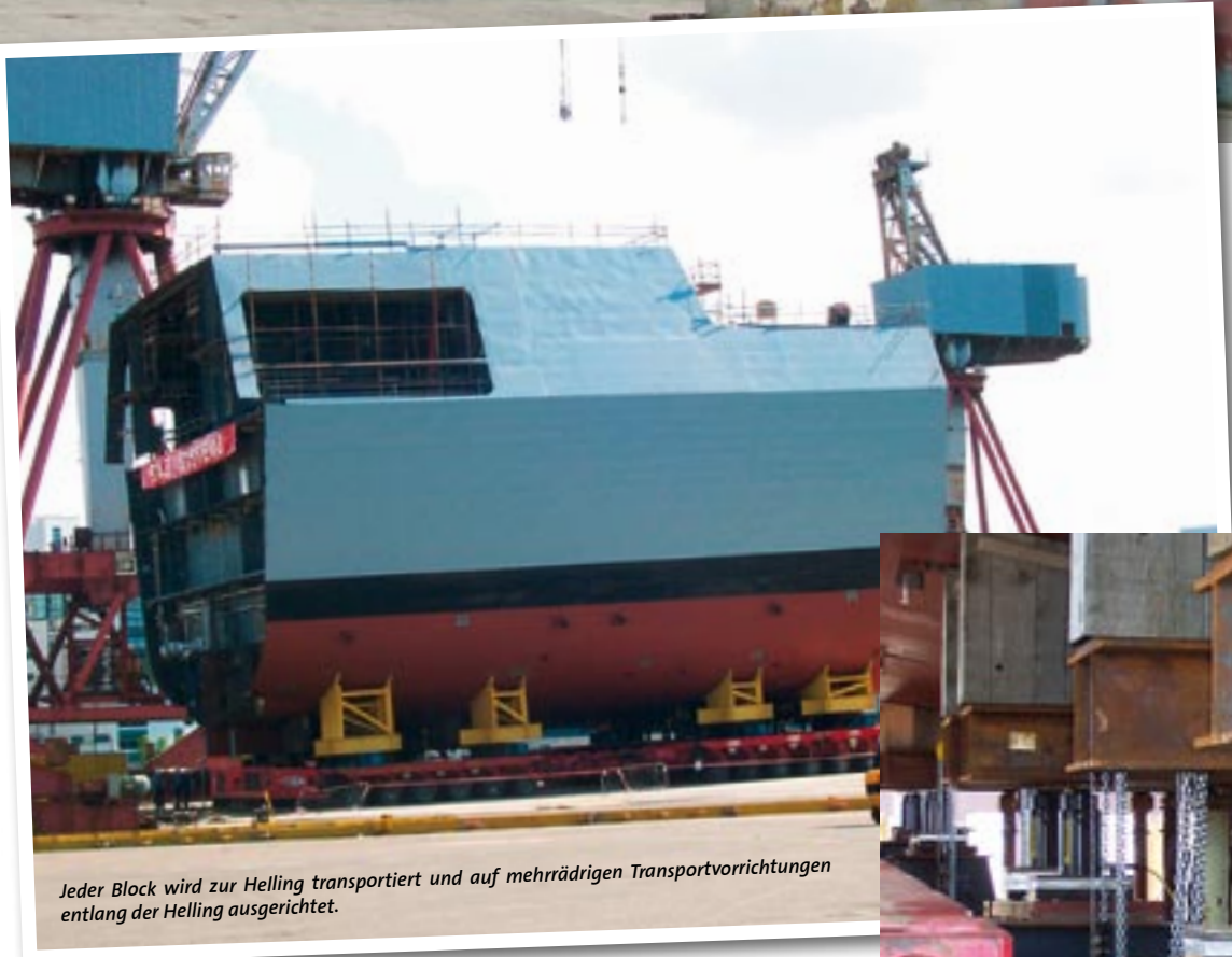
Das Rumpfsegment des Marineschiffs Typ 45 unterwegs zum Govan Pier. Insgesamt müssen fünf Blöcke bewegt werden, um ein Schiff zu bauen; der schwerste Block wiegt über 1.400 t.
