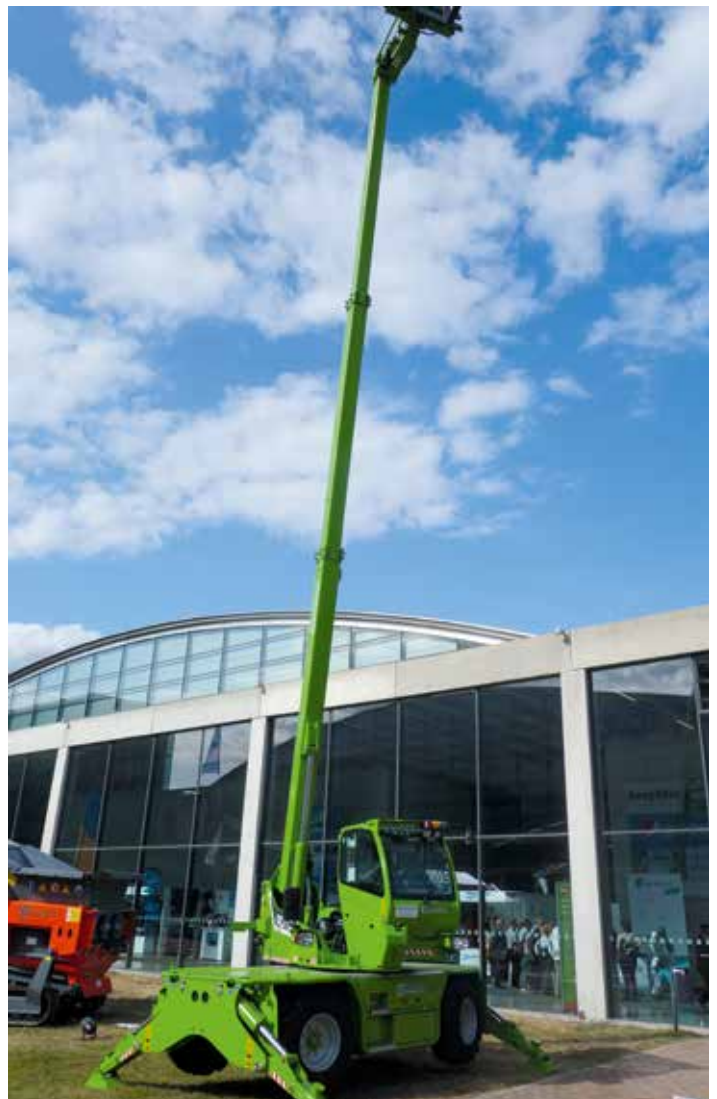
... der Teleskopstapler Roto R 40.16 S von Merlo, ... BM-Bild
