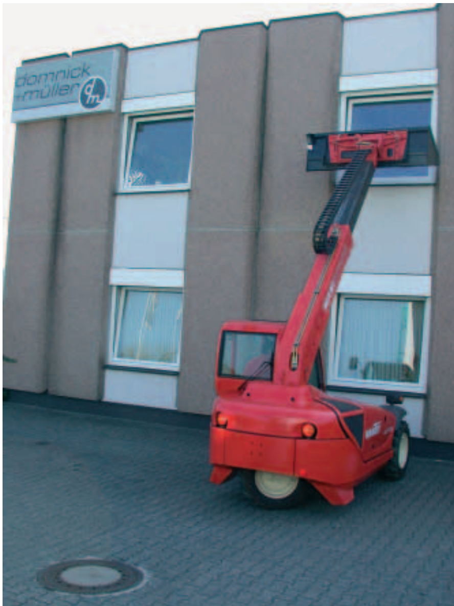
Der Twisco verfügt über eine Hubhöhe von 4 m. Somit können problemlos Materialien auf die Höhe des ersten Stockwerks eines Gebäudes gebracht werden, wie das Bild verdeutlicht. BM-Bild
