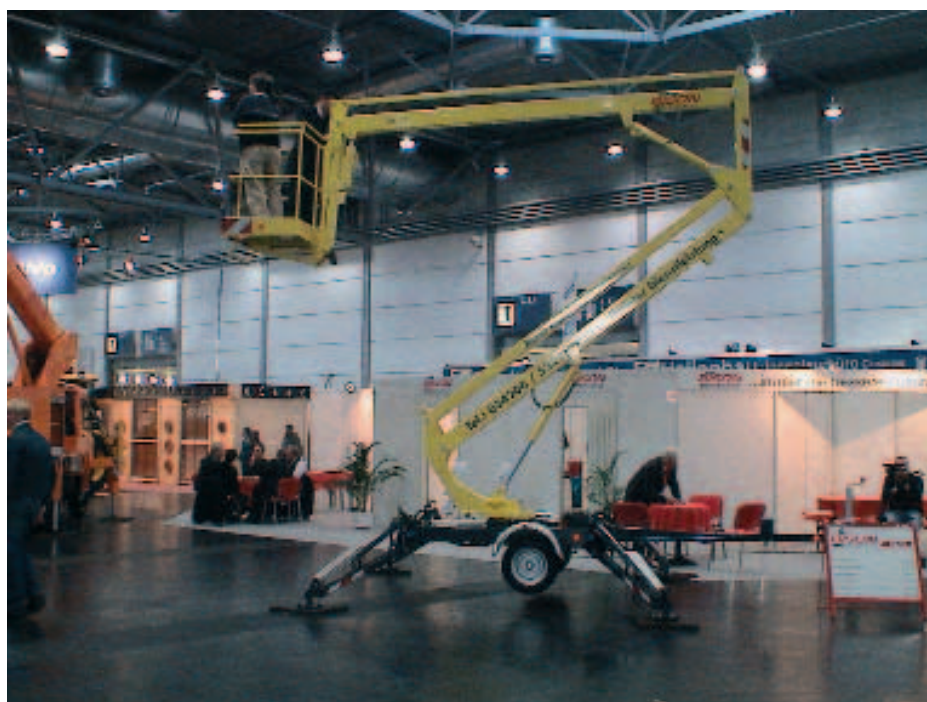
Gelenkig. Die Anhänger-Arbeitsbühne GK 12 von Bison stematec ist mit einer 4-Gelenk-Technik ausgestattet.
