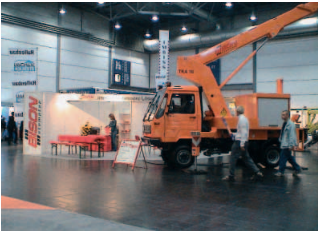
Kompakt wurde die Hubarbeitsbühne TKA 16 präsentiert. Das 16 m-Gerät war auf einem Multicar aufgebaut.
