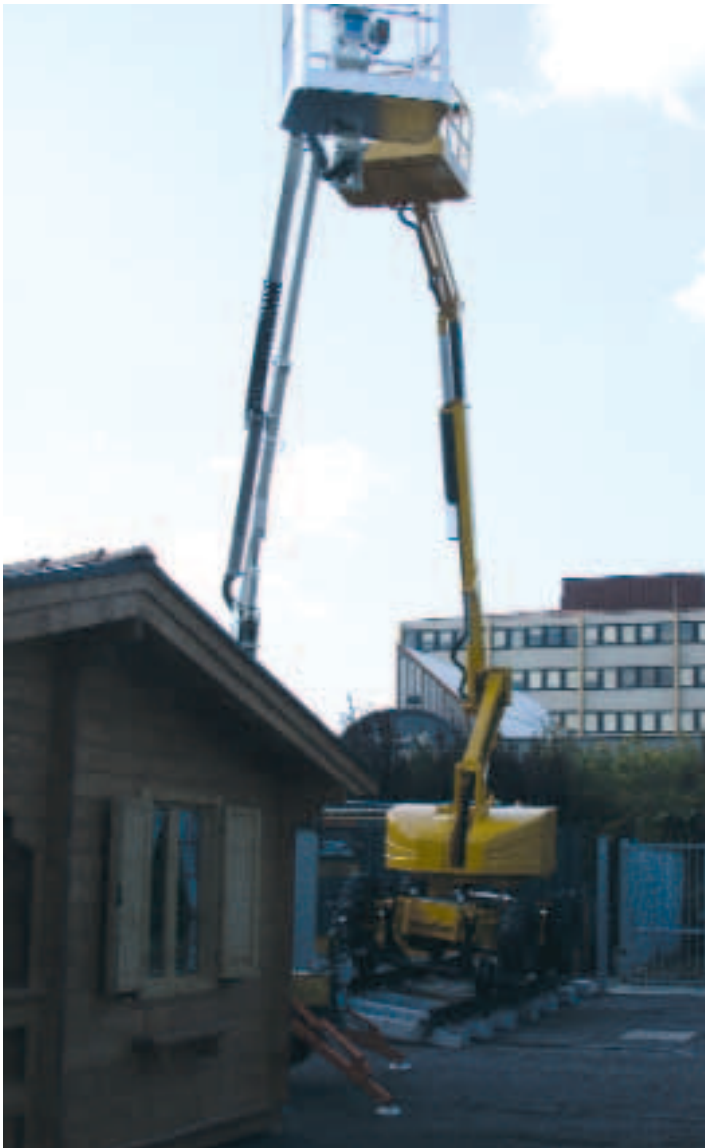
Die selbstfahrende Gelenkteleskop-Arbeitsbühne 14 RR von Basket kann sowohl auf der Straße als auch auf Schienen zum Einsatz kommen. BM-Bild
