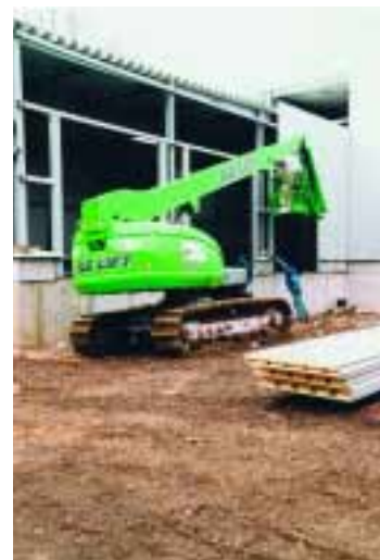
Schwenkbarer Korbarm und drehbarer Arbeitskorb erleichtern das Positionieren der Plattform.
