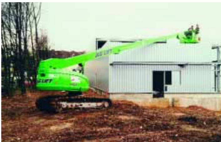
55 % Steigfähigkeit und 38 cm Bodenfreiheit prädestinieren die 660 SJC für den schweren Geländeeinsatz.
