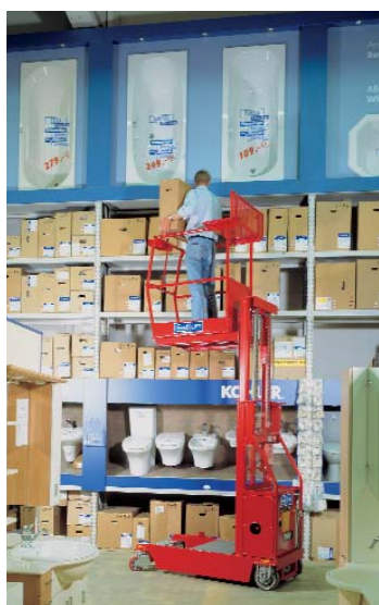
Die neu entwickelte selbstfahrende Hubarbeitsbühne Kuli-Lift KBE 5 der Helmut Kempkes GmbH, Kuli-Hebezeuge, im Einsatz.
