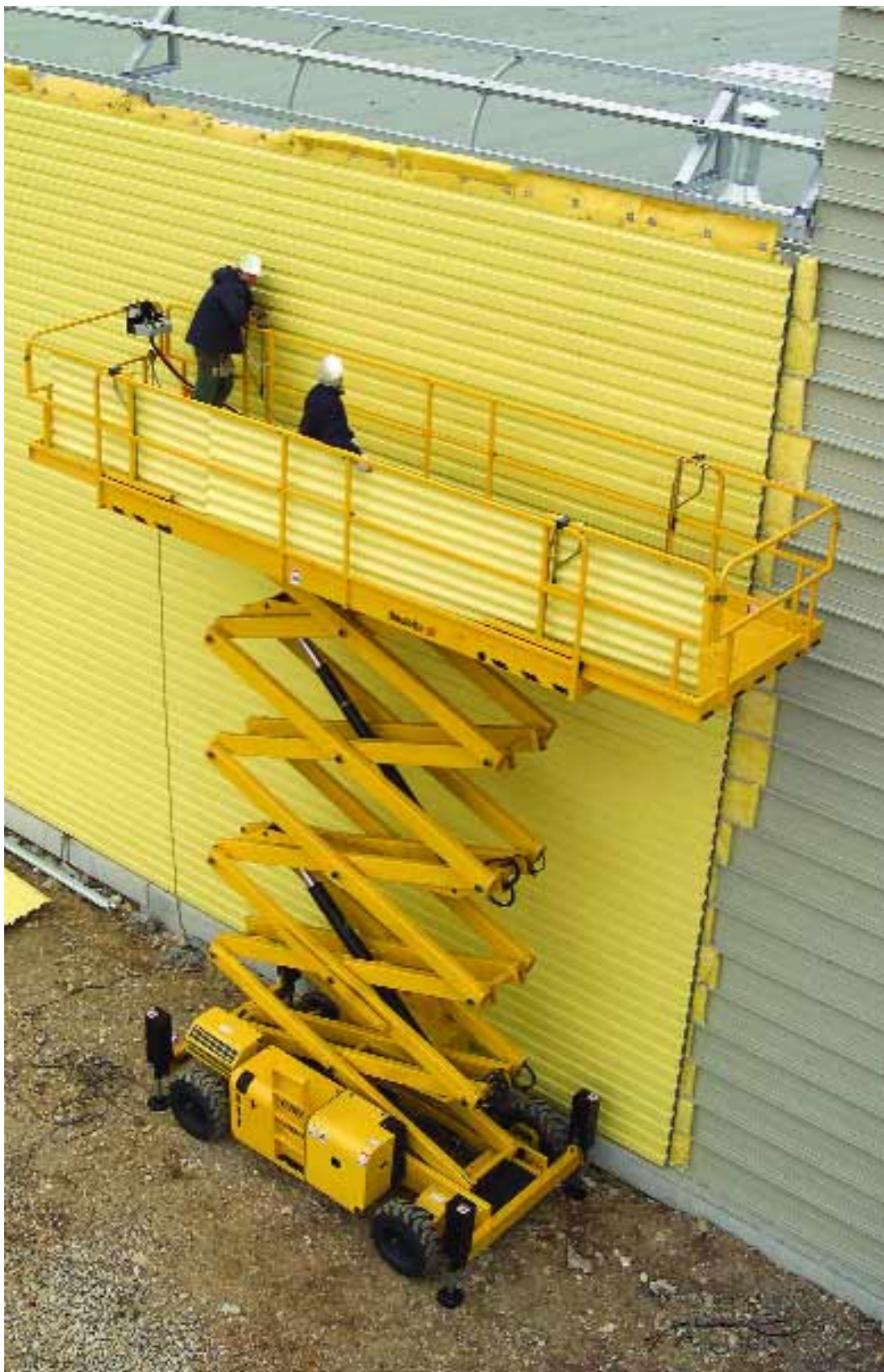
Die neue Scheren-Arbeitsbühne H12SXL bietet 12 m Arbeitshöhe, maximal 700 kg Tragfähigkeit und beachtliche 7,3 m maximale Plattformlänge. Letzteres ermöglicht die problemlose Mitnahme auch großer Fassadenteile.
