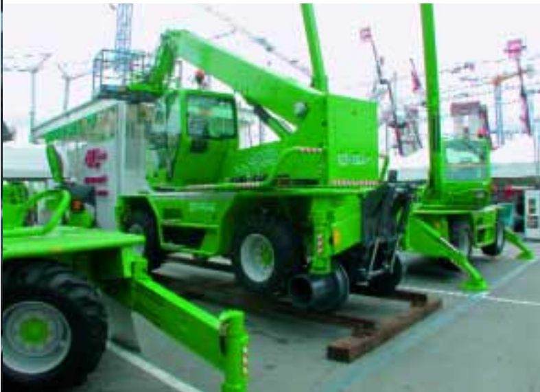
War beispielsweise auf der Saie 2004 ausgestellt: ein Teleskopstapler mit Arbeitskorb, umgerüstet zum Schienenfahrzeug. BM-Bild
