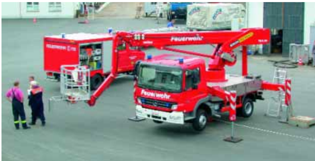
Befand sich beim BM-Besuch gerade im Testlauf: eine zur Hubrettungsbühne umgebaute TKA 28 KS von Bison Palfinger. BM-Bild
