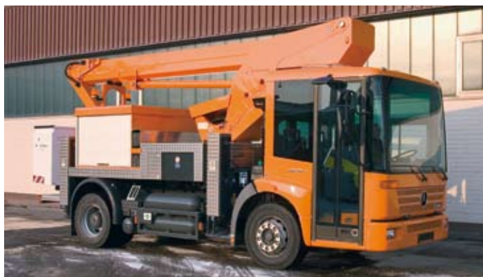
Keine Trägerfahrzeugwünsche bleiben laut Hersteller unerfüllt. Für einen Energieversorger aus Baden-Württemberg baute Ruthmann den T 270 „S“ auf einem Mercedes-Econic-Fahrgestell mit Erdgasantrieb auf.
