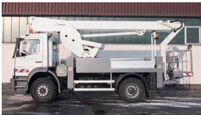
Kurzer Radstand und geringe Baulänge. Trotz 18-Tonner-Fahrgestell kommt der T 270 auch in engen Gassen und im dichten Großstadtverkehr gut zurecht.
