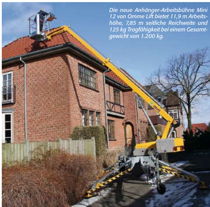
Der bewegliche Korbarm bietet flexible Bewegung und erleichtert somit das Arbeiten beispielsweise an Dachvorsprüngen.
