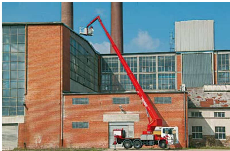
Auch die TKA 47 KS schwenkt dank Kurbelschwenktisch innerhalb der Fahrzeugbreite.
