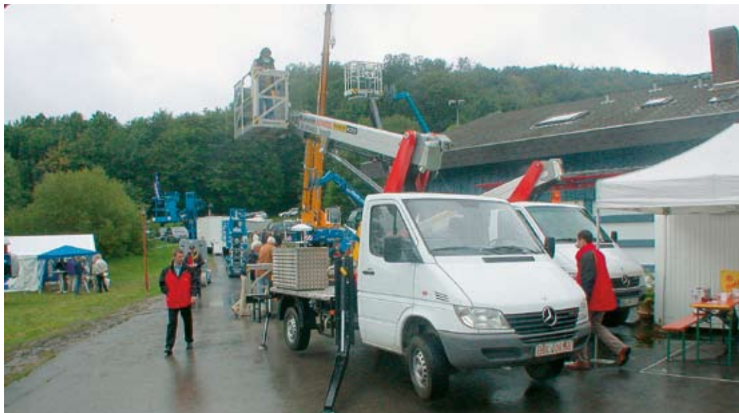
Wird ebenfalls auf der Intermat in Paris zu sehen sein. Die Lkw-Arbeitsbühne TA 20 von Bison Palfinger. Aufgebaut ist die Maschine auf Fahrgestelle mit einem zulässigen Gesamtgewicht von bis zu 3,5 t. BM-Bild
