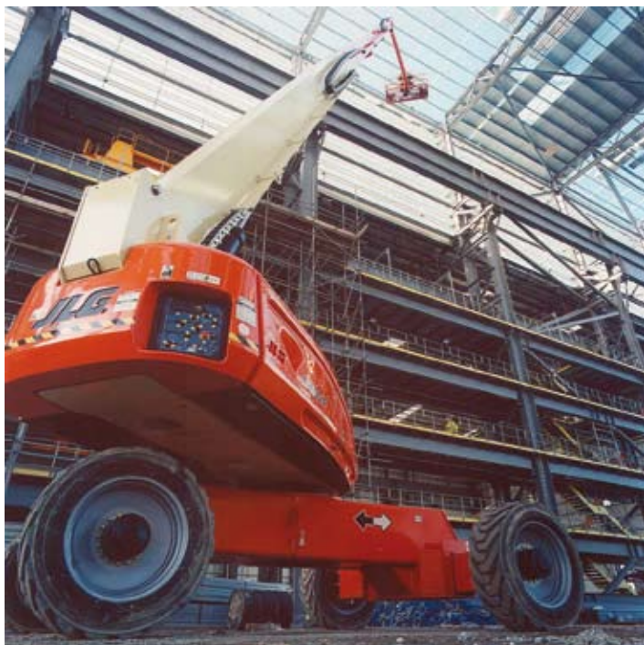
Die Teleskop-Arbeitsbühne 1350SJP von JLG, die auch auf der Intermat ausgestellt sein wird, ermöglicht Arbeiten in bis zu 43,15 m Höhe.
