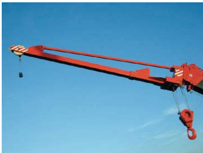
Als weitere Zusatzausrüstung steht für größere Höhen noch eine 3 m Spitze zur Verfügung, bei der der Arbeitswinkel auf 5° oder 15° (Bild) verstellt werden kann.
