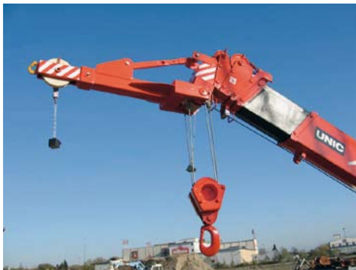
Der modifizierte Unic A506-5 kann mit einer 1 m langen – hier um 20° abgewinkelten – Schwerlastspitze ausgestattet werden, die ...
