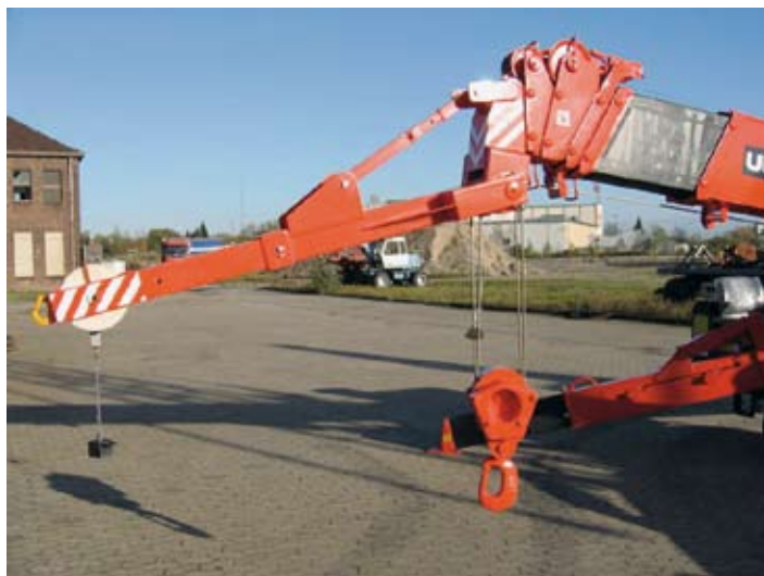
... manuell um 0,5 m auf 1,5 m ausgefahren werden kann sowie auch um 5° abgewinkelt zum Einsatz kommen kann.
