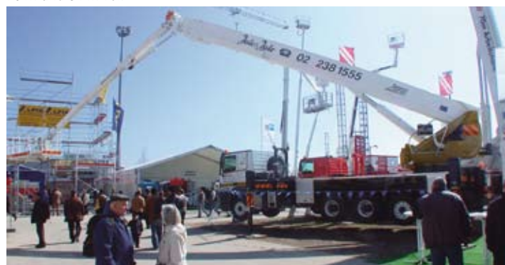
Steht ebenfalls im Groß-Lkw-Bereich zur Auswahl: bis zu 61 m Arbeitshöhe mit 9 m teleskopierbarem Korbarm, um 90° drehbarem Arbeitskorb und maximal 700 kg Tragkraft. BM-Bild
