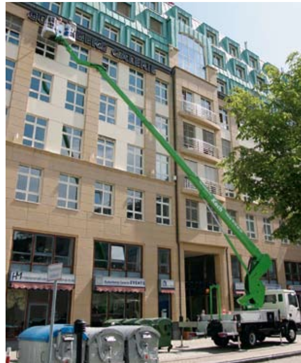
Die Neon-Leucht-Reklame der Gutenberg-Galerie in Leipzig wird überprüft. Einige Neonkonturen sind durch die Hagelkörner zerstört worden. Nachdem der RuthmannSteiger® T 270 aufgestellt war, konnte die komplette Werbeanlage inspiziert werden.
