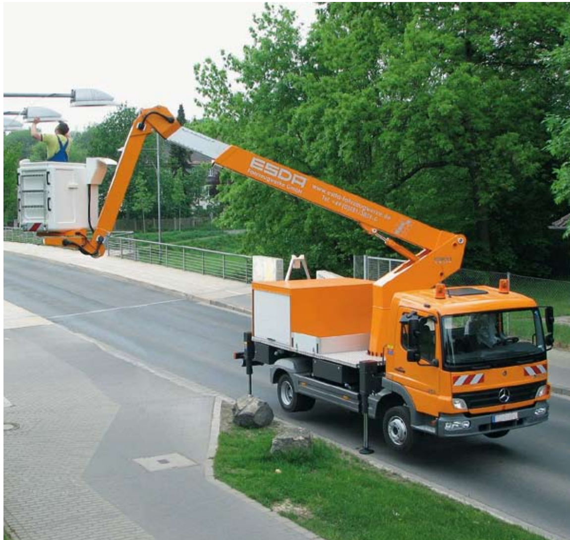
Feierte auf der Kommunal Live in Hannover Mitte Mai Premiere: Die Lkw-Arbeitsbühne TG 1700 der ESDA Fahrzeugwerke GmbH, die auf einem MB Atego mit BlueTec-Technologie aufgebaut ist.
