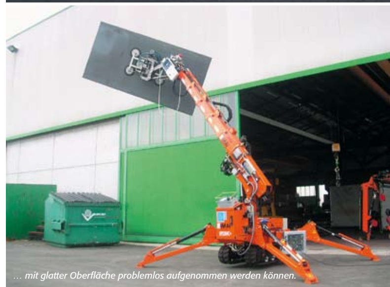
Der Minikran SPD 265C+ mit Glassauger, mit dem Bauteile ...
