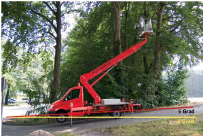
Eine weitere Ruthmann-Innovation in dieser Arbeitsbühnen-Klasse ist die 5° zulässige Aufstellneigung bei automatischer Reichweitenanpassung. So kann die Arbeitsbühne auch an schrägen oder unwegsamen Standorten einfach und mühelos aufgestellt und in Betrieb genommen werden.
