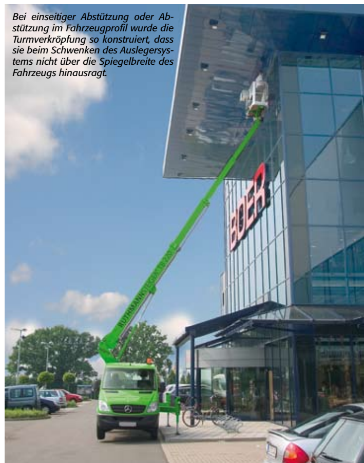
Durch die innovative horizontal/vertikale Abstützung kann der Steiger® TB 220 je nach Platzverhältnissen einseitig, beidseitig oder nur im Fahrzeugprofil abgestützt werden.
