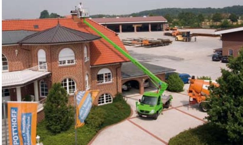
Die neue Generation des TB 220 bietet eine Reichweite von 14 m.
