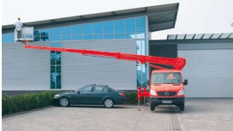
Durch die innovative horizontal/vertikale Abstützung kann der Steiger® TB 220 je nach Platzverhältnissen einseitig, beidseitig oder nur im Fahrzeugprofil abgestützt werden.
