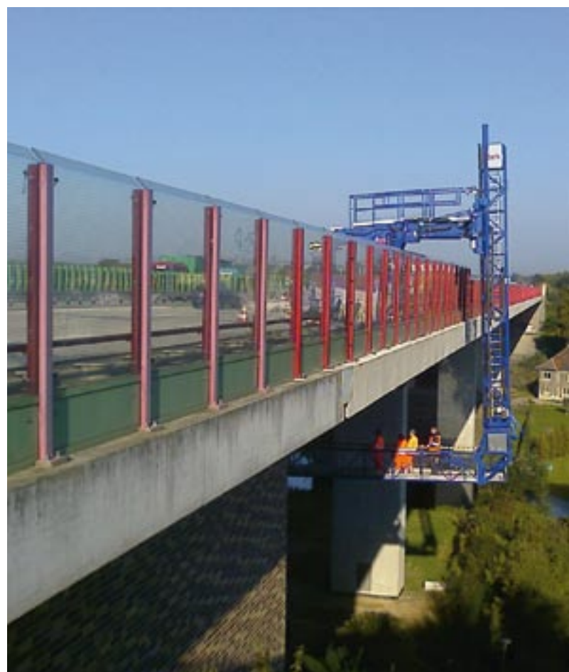
Einsatz auf einer Autobahnbrücke: Der Standstreifen plus die Sperrung der rechten Fahrspur reichen für den Einsatz aus. So kann der Verkehr auf den verbleibenden zwei Spuren problemlos weiter fließen.
