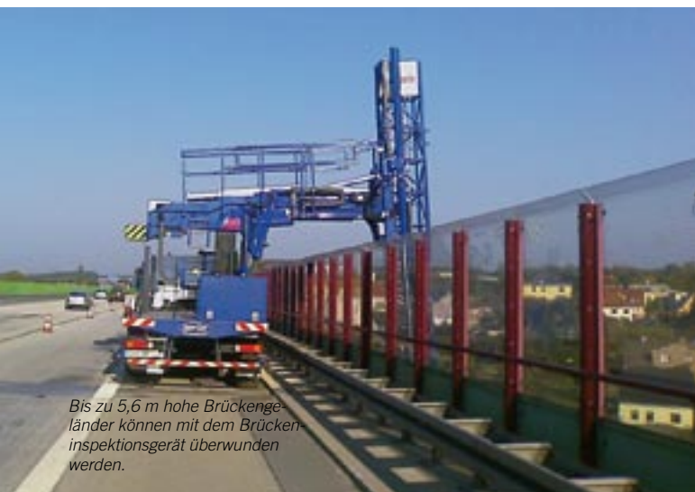
Einsatz auf einer Autobahnbrücke: Der Standstreifen plus die Sperrung der rechten Fahrspur reichen für den Einsatz aus. So kann der Verkehr auf den verbleibenden zwei Spuren problemlos weiter fließen.
