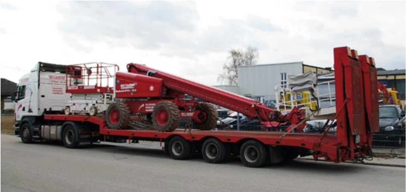
Bereit für den nächsten Einsatz. Eine dieselgetriebene Teleskop-Arbeitsbühne auf einer Transporteinheit. Insgesamt umfasst der Maschinenpark des Waghäuseler Unternehmens 12 große Teleskopmaschinen mit über 20 m Arbeitshöhe.
