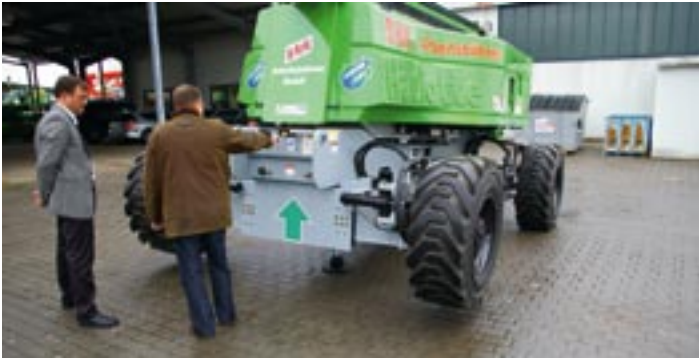
Bevor die Achsen hydraulisch ausgeschoben werden, wird das Chassis der HA 32 PX vorne beziehungsweise hinten mit einer hydraulischen Stütze angehoben. BM-Bild
