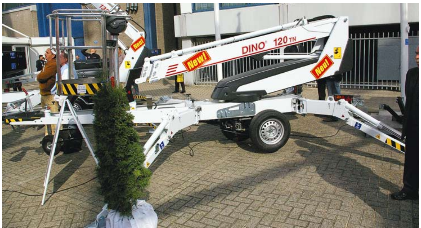
Bei der neuen Anhänger-Arbeitsbühne Dino 120TN kann die Achsbreite auf 0,88 m per Knopfdruck reduziert werden.
