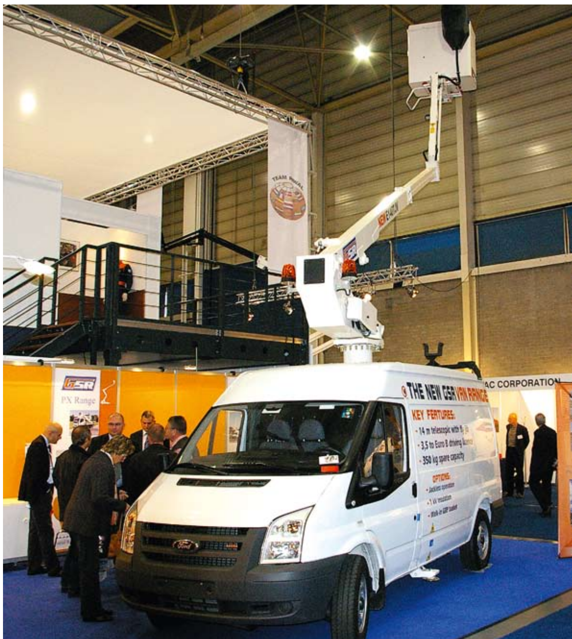
BM GSR präsentierte auf der Apex die neue Teleskop-Lkw-Arbeitsbühne E140TJV, die auf einen 3,5 t-Kastenwagen aufgebaut wird. BM-Bild
