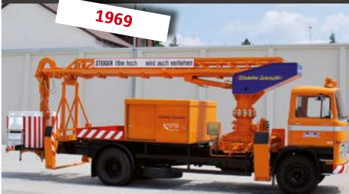
STEIGER® K 170: 19 m Höhe, 16 m Reichweite, 15 t ZGG.
