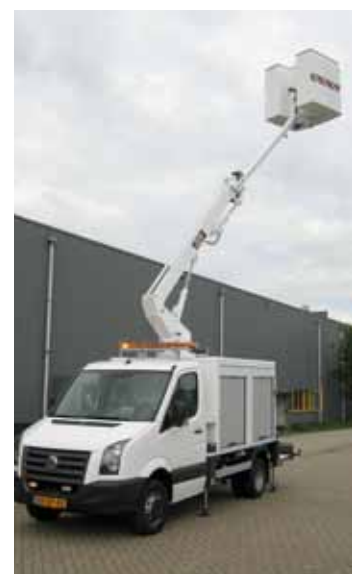
Der neue Taurus 200-10.5 stützt innerhalb des Fahrzeugprofils ab. Zusätzlich kann die Hubarbeitsbühne auch ohne Stützen zum Einsatz kommen.
