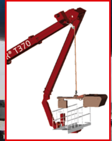
Durch den am Hauptausleger des T 370 A-E angebauten Kran ist dieses Steiger-Modell für alle Wartungs- und Reparatur-Arbeiten am Airbus A 380 gewappnet, ohne Rüstzeiten zu verursachen.
