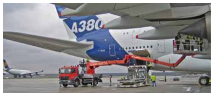
Außerdem bietet der von 2,3 auf 3,6 Meter austeleskopierbare und mit einer Nutzlast von bis zu 500 kg ausgestattete Arbeitskorb des T 370 A-E genügend Platz für bis zu fünf Mechaniker und deren Werkzeug.
