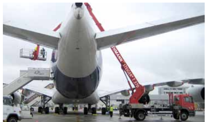
Weiteres Highlight beim T 370 A-E ist der bewegliche Korbarm (bei Ruthmann Rüssel genannt) am Ende des Teleskopauslegersystems. Ohne die Arbeitsbühneneinheit zu versetzen, kann problemlos auch auf der gegenüberliegenden Flugzeugseite gearbeitet werden.
