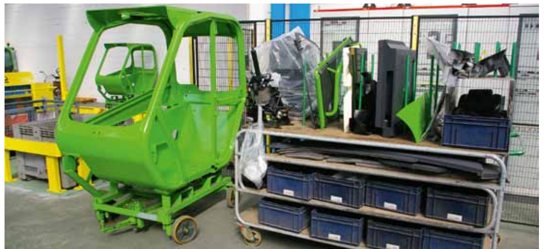
Auf solchen Rollwagen finden sich alle Bauteile für die Montage einer Kabine. BM-Bild
