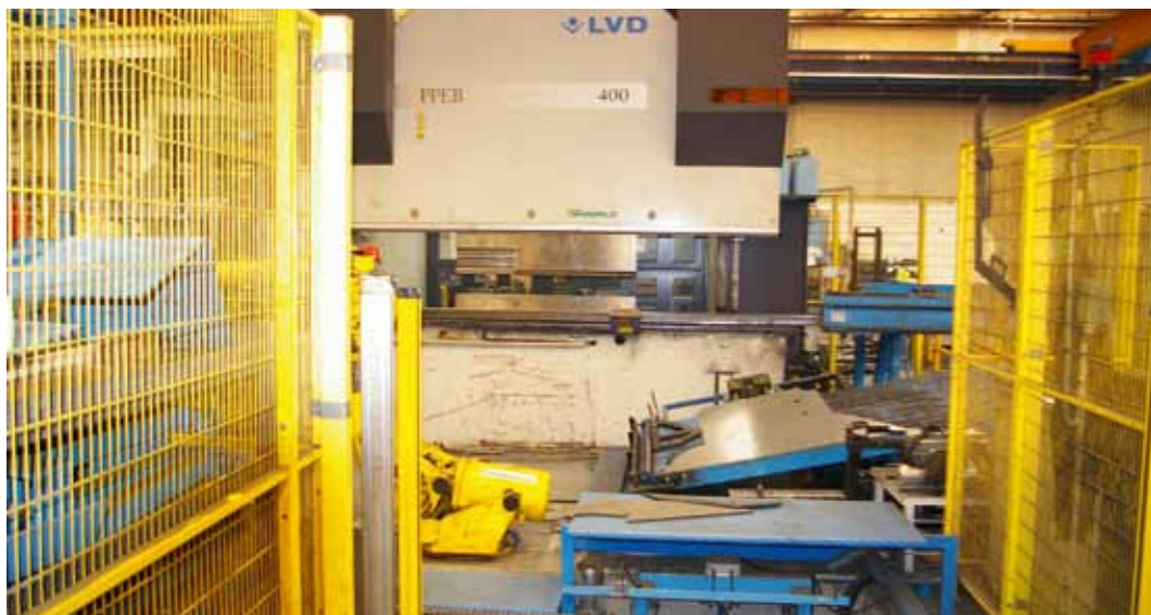
Automatisierte Blechkantung. Ein Roboter nimmt die Bleche auf und führt sie der Kantmaschine zu.
