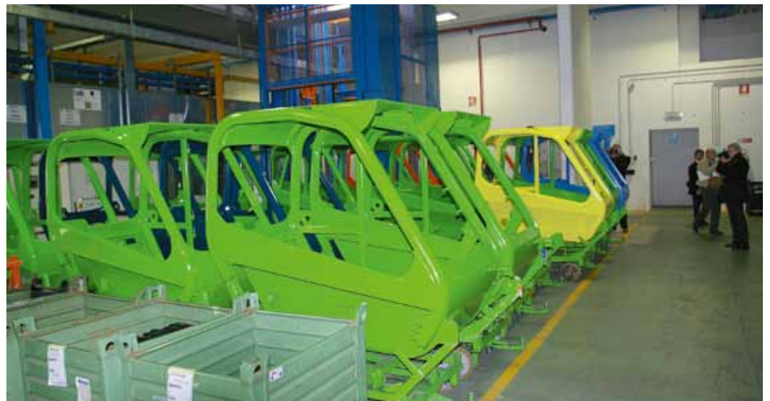
Nach der Lackierung warten die Kabinen-Grundgerüste auf ihren Zusammenbau in direkter Nachbarschaft. BM-Bild
