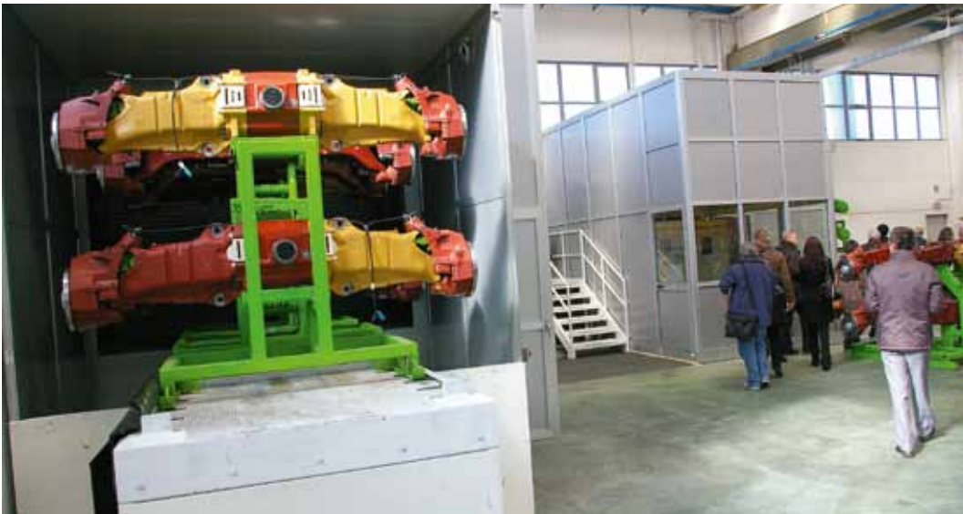
Voll automatisierte Lackierstraßen der Achsen. Vorne laufen die Achsen rein und hinten rechts im Bild lackiert wieder heraus. BM-Bild
