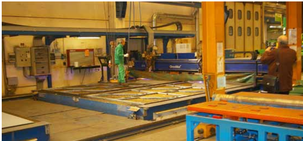
Mit diesem Plasmaschneider kann bis zu 20 cm dicker Stahl geschnitten werden.
