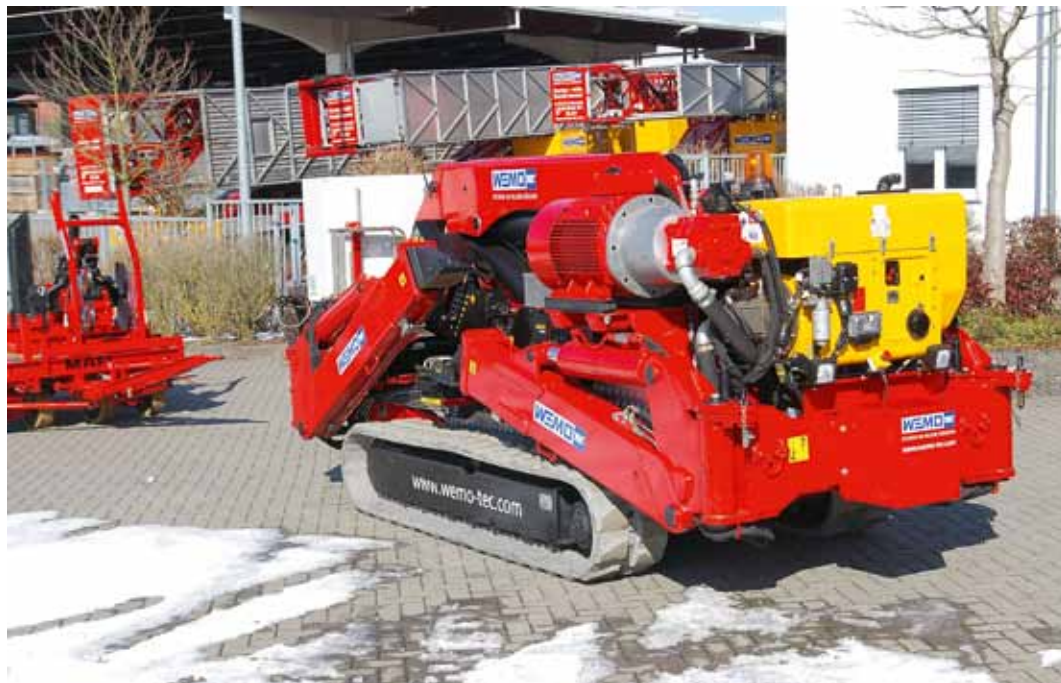
Kompaktes Kraftpaket: der SMK 320.67 mit 1,75 m Breite und 1,98 m Höhe.
