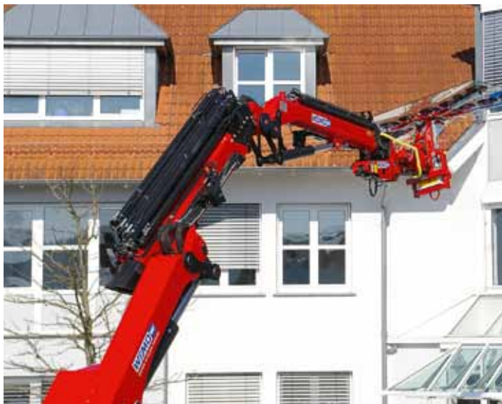
Dank der Schnellwechsel-Vorrichtung lässt sich problemlos vom Zangengreifer auf Vakuumglassauger wechseln. BM-Bild
