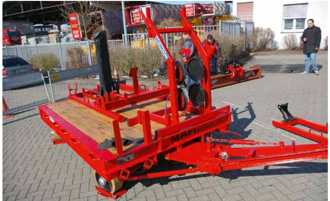
Die gesamten Anbaugeräte werden auf diesem Rüst-Satz-Träger transportiert.
