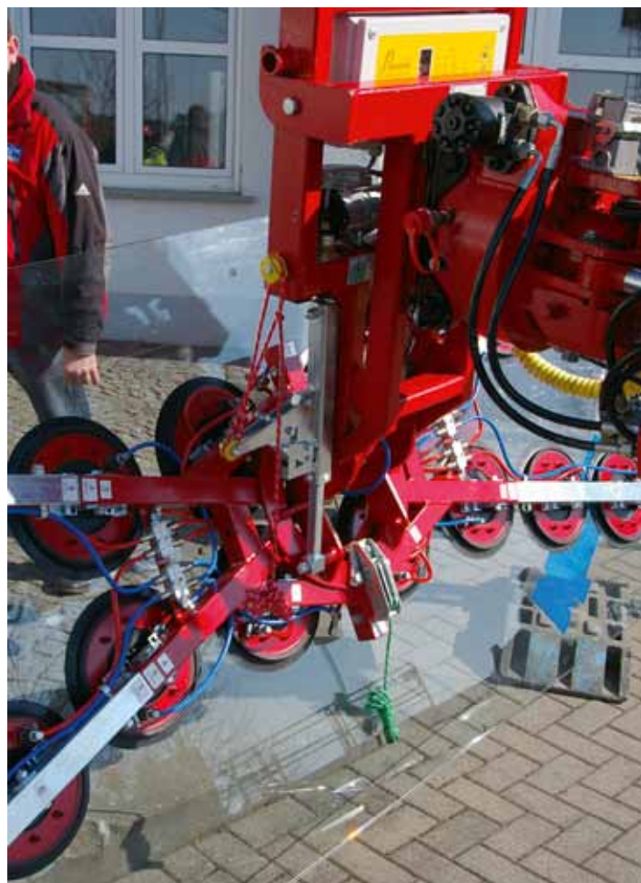
Neben den großen hydraulischen Drehwinkeln des Manipulators kann der Vakuumsauger noch manuell seitlich und nach vorne/hinten gekippt werden (siehe Zahnstange im Bild).
