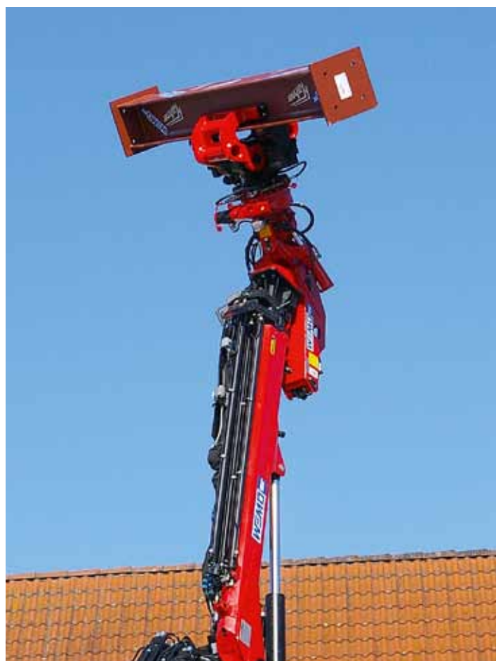
Stahlträger können mit dem Manipulator direkt unter einer Decke eingebracht werden. BM-Bild
