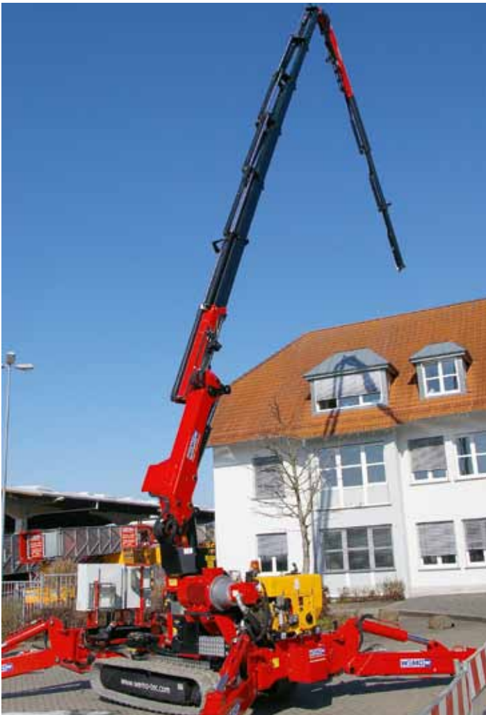
Mit Jib bietet der SMK 320.67 eine maximale Hakenhöhe von 28 m.
