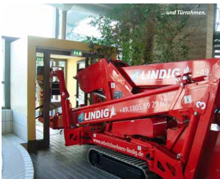
Dank der hohen Reichweite von 11 m konnten alle Dachbalken erreicht werden.
