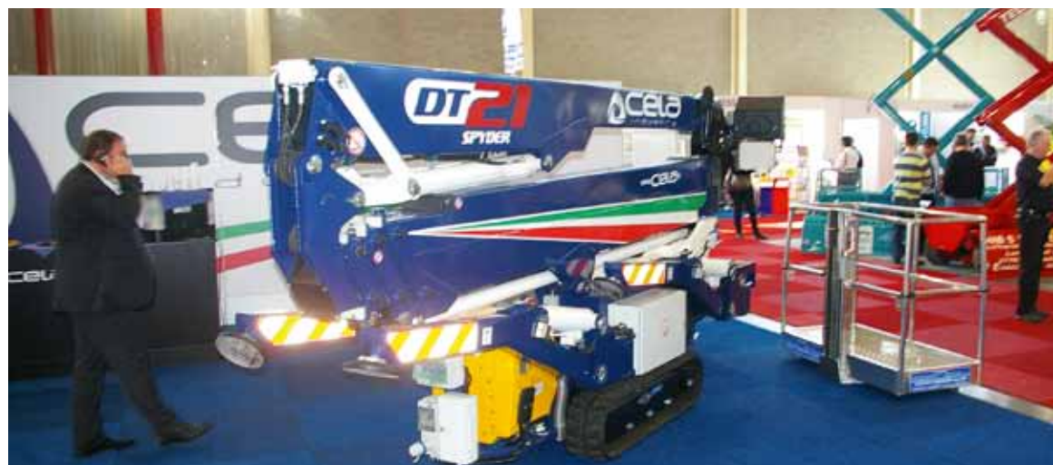
Bei der DT 21 Spyder auf Raupenfahrwerk kommt der gleiche Bühnenaufbau wie bei der Lkw-Arbeitsbühne DT 21 zum Einsatz. BM-Bild
