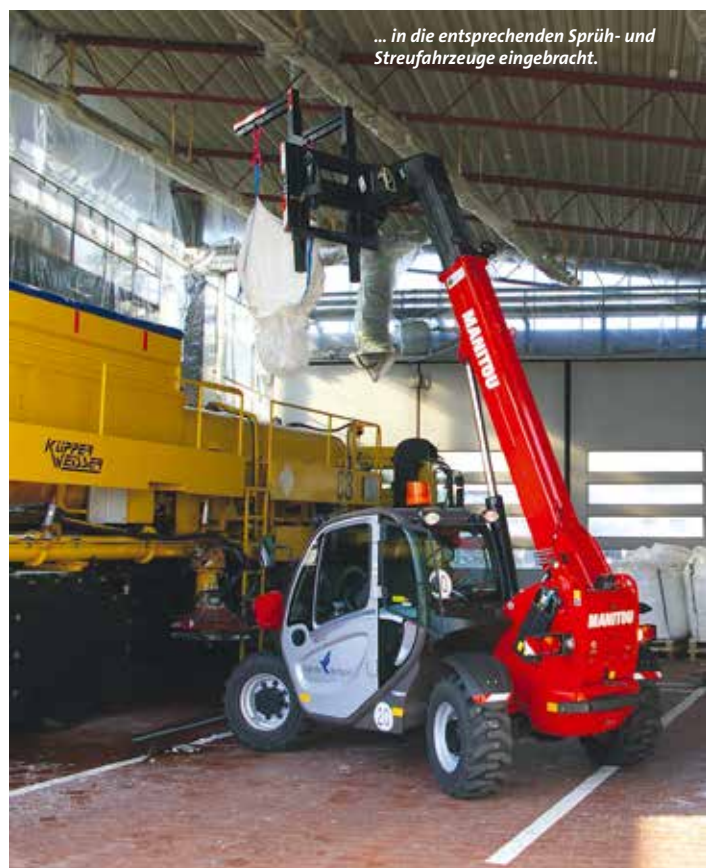
Eines von vielen Aufgabengebieten für die Manitou-Teleskopstapler vom Typ MT 625 bei der Flughafenfeuerwehr Stuttgart: Mit einem speziellen Aufnahmemittel wird beispielsweise Enteisungsgranulat ...
