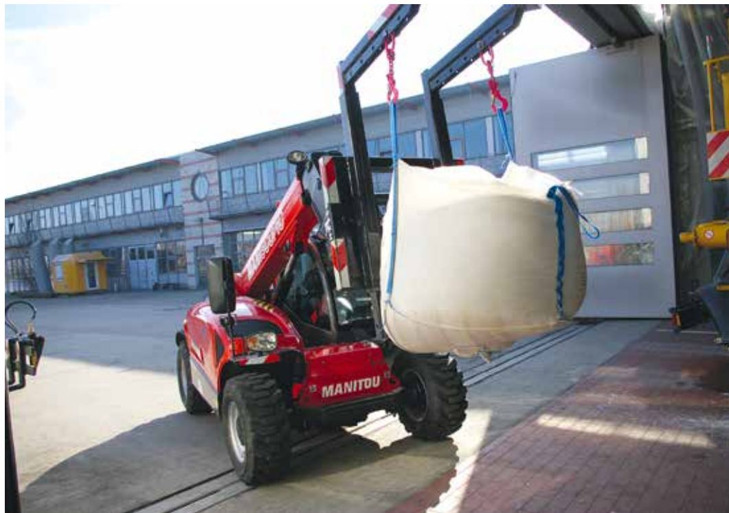
Eines von vielen Aufgabengebieten für die Manitou-Teleskopstapler vom Typ MT 625 bei der Flughafenfeuerwehr Stuttgart: Mit einem speziellen Aufnahmemittel wird beispielsweise Enteisungsgranulat ...
