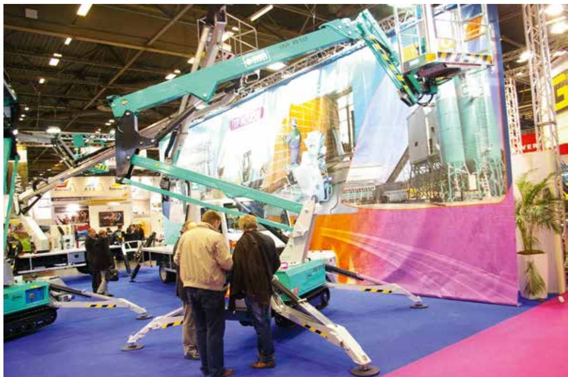
Imer Access präsentierte auf der Intermat zwei neue Raupen-Arbeitsbühnen: die IM R 19 mit 19 m Arbeitshöhe ...
