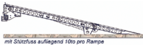
mit Stützfuss aufliegend 10to pro Rampe
