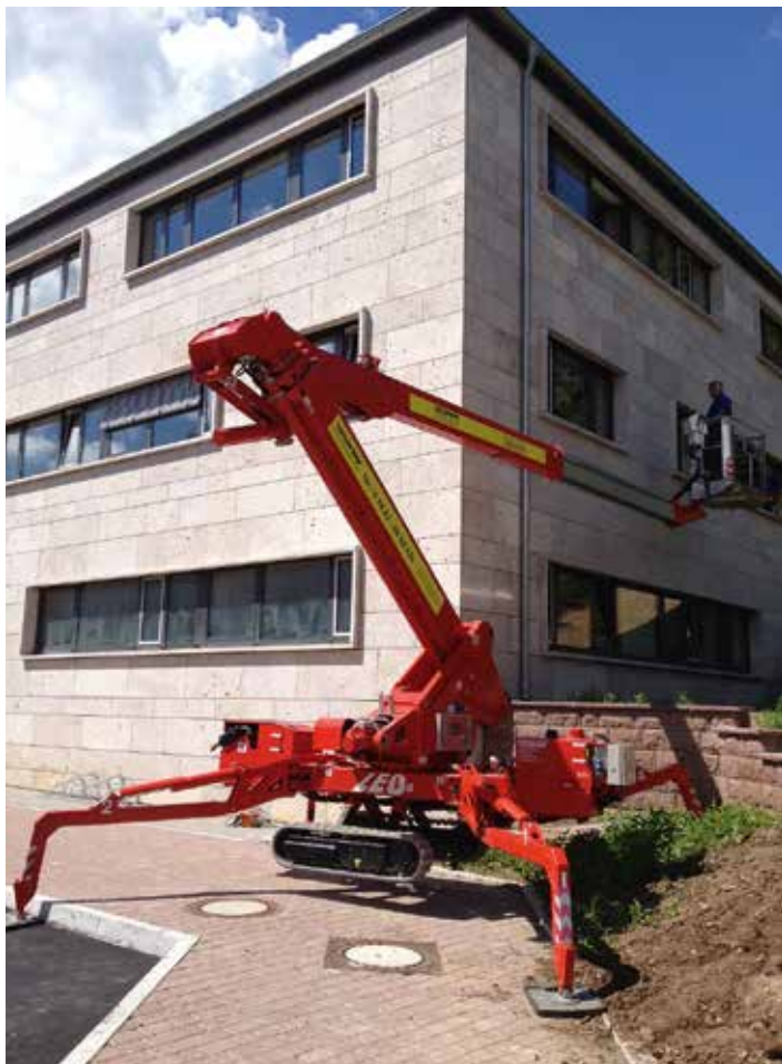
Dank der neuen Raupen-Arbeitsbühne SGTR 230 von Schwenk Arbeitsbühnen konnte die Glasreinigung schnell und sicher durchgeführt werden.
