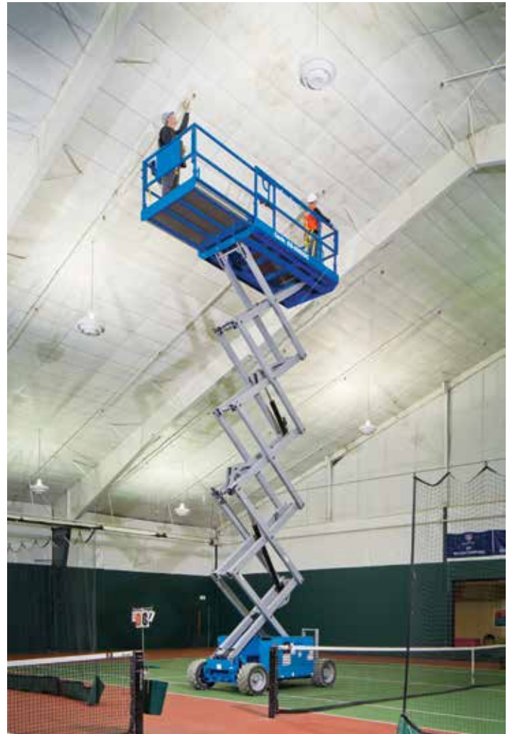
Die neue Elektro-Scheren-Arbeitsbühne GS-4069 DC von Genie ist sowohl für Indooreinsätze – wie hier – als auch für Outdooreinsätze geeignet.
