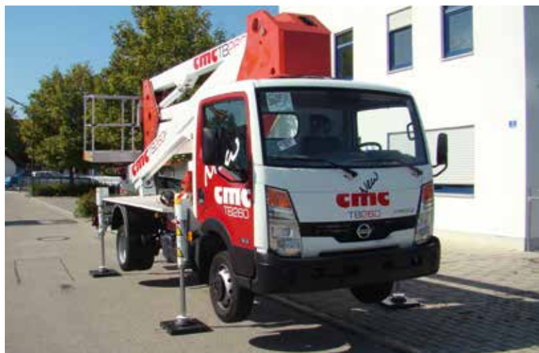
Die Kunze GmbH zeigt auf den Platformers' Days die neue Lkw-Arbeitsbühne TB 260 auf 3,5-t-Chassis, die verschiedene Abstützvarianten bietet.
