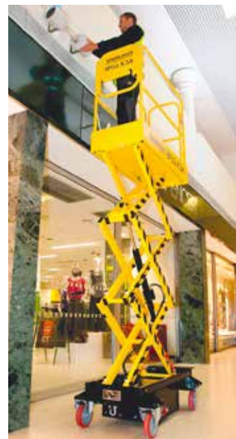
Die Micro-Scheren-Arbeitsbühne Boss X3X ist mit 5,20 m Arbeitshöhe bei nur 390 kg variabel einsetzbar.
