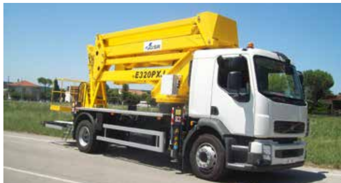
Neu bei GSR: E320PXJ: 32 m Arbeitshöhe, 20 m seitliche Reichweite bei 280 kg Korblast und serienmäßig variable Abstützung – die bislang größte von GSR je vorgestellte Arbeitsbühne.
