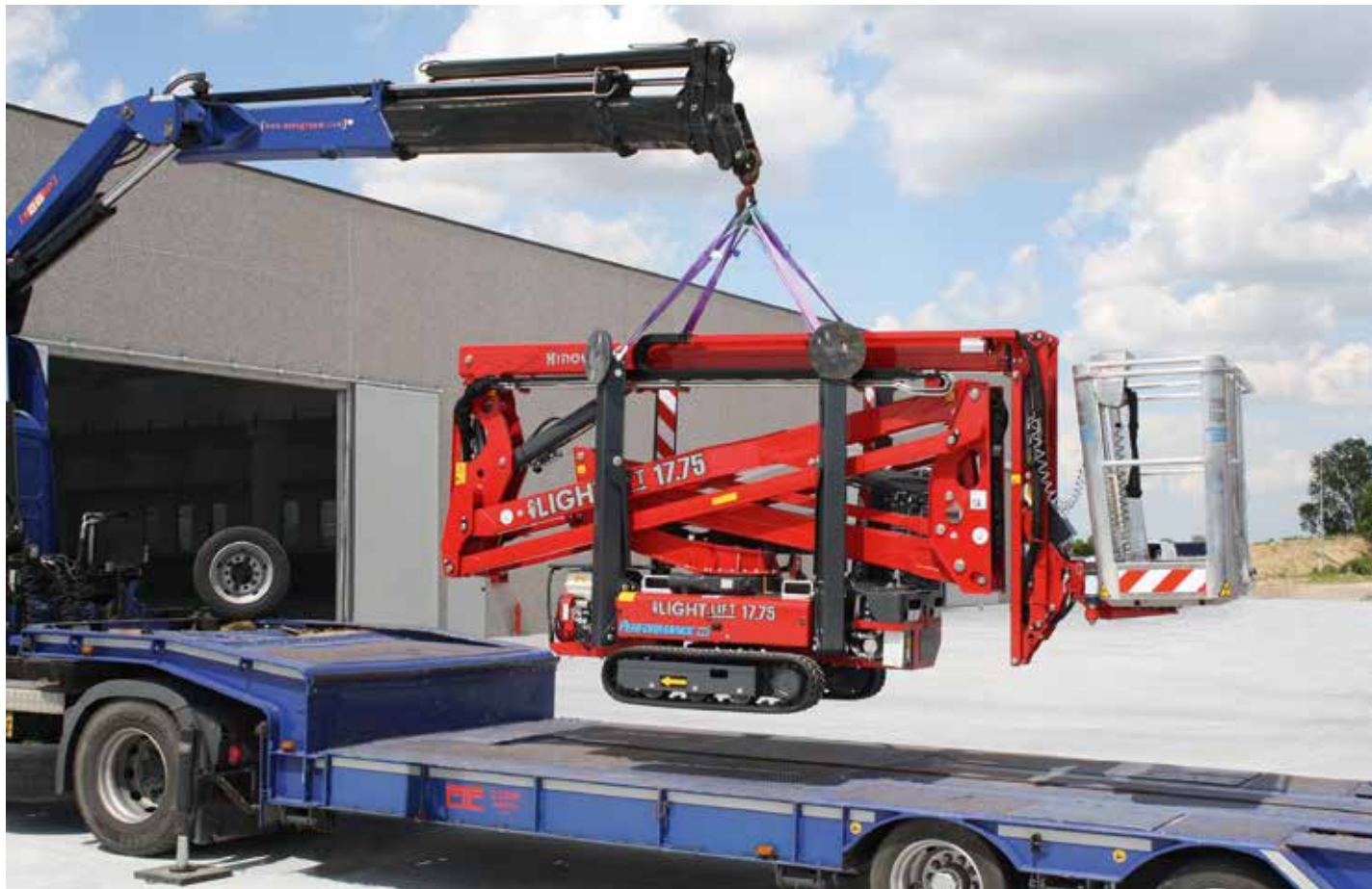
Am Haken: die neue LightLift 17.75 Performance IIS von Hinowa wird auf ein Transportfahrzeug verladen und ...
