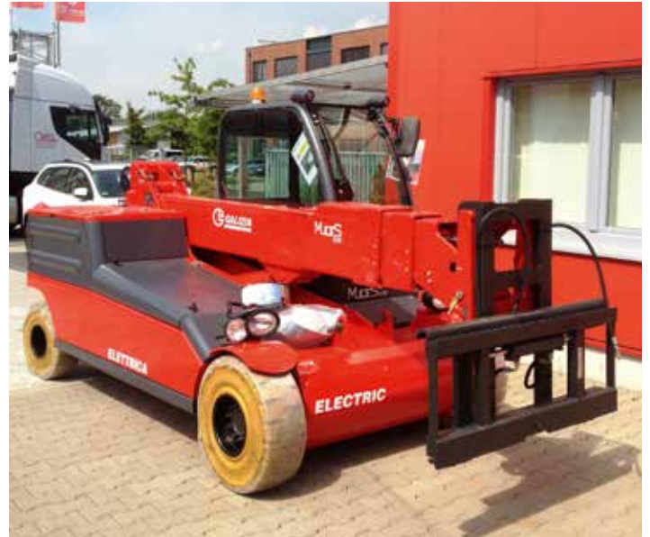
Der GALIZIA MULTIS 636 Telestapler mit Elektro-Antrieb kann mit verschiedenen Anbaugeräten, wie Gabelzinken, Arbeitskorb, Schaufel oder Kranhaken ausgestattet werden.
