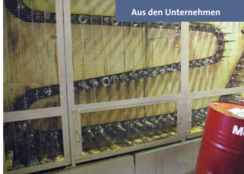
... insgesamt 150 Werkzeugen, die automatisch ausgewählt werden.
