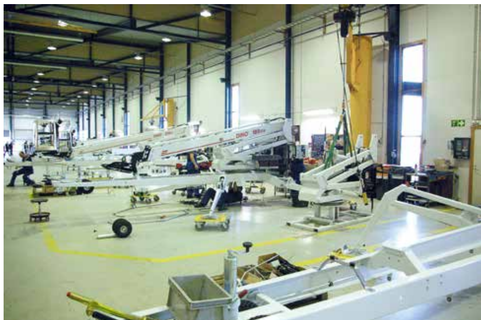
Endmontage von Dinolift-Arbeitsbühnen.
