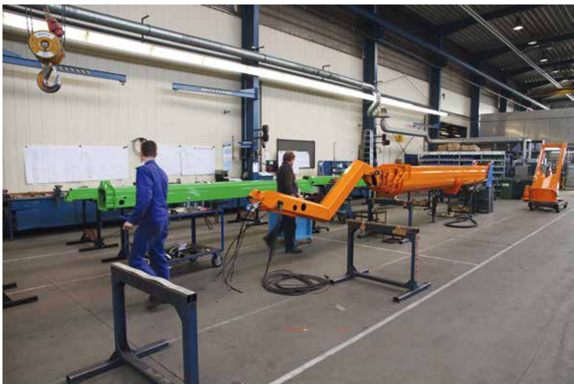
Auslegermontage – auch der Drehturm steht schon bereit.
