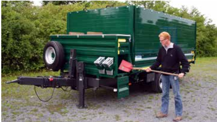
Dass Blumenröhr Extras am Kipper umsetzen kann, hat das Unternehmen bei einem Kunden aus Bitburg gezeigt: Ein doppelter Staukasten bietet viel Stauraum für kleinere Materialien. Die Aufsatzbordwände aus Aluminium mit zwei Zurrschienen und Netzhaken garantieren eine Menge Ladevolumen für Schüttgüter. In der Heckklappe wurde ein Dosierschieber integriert, um ein gezieltes Abkippen zu ermöglichen. Die zusätzlichen Lasthaken und Zurrmulden lassen eine sichere Verzurrung verschiedener Maschinen zu. Um den Kipper autark bedienen zu können, wurde eine Elektro-Hydraulik-Pumpe eingebaut. Alles in allem ein vielseitiger Anhänger.
