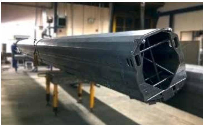
Bei den Auslegern des T 7XX verwendet Ruthmann High-Tech-Feinkornstähle der neuesten Generation.
