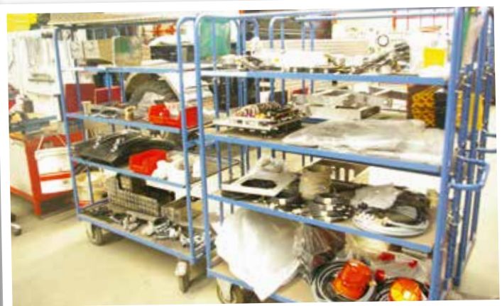
Für die Endmontage einer Hubarbeitsbühne werden immer zwei Materialwagen hergerichtet: einer mit den Elektronikbauteilen (re.) und einer mit den mechanischen Bauteilen. BM-Bild
