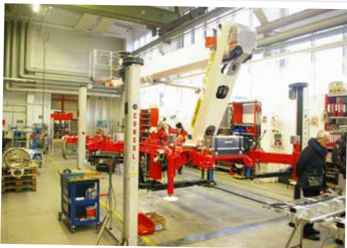
Derzeit werden in Löbau in dieser Montagestraße in zwei Wochen neun Lkw-Arbeitsbühnen aus dem 3,5-t-Segment montiert. BM-Bild
