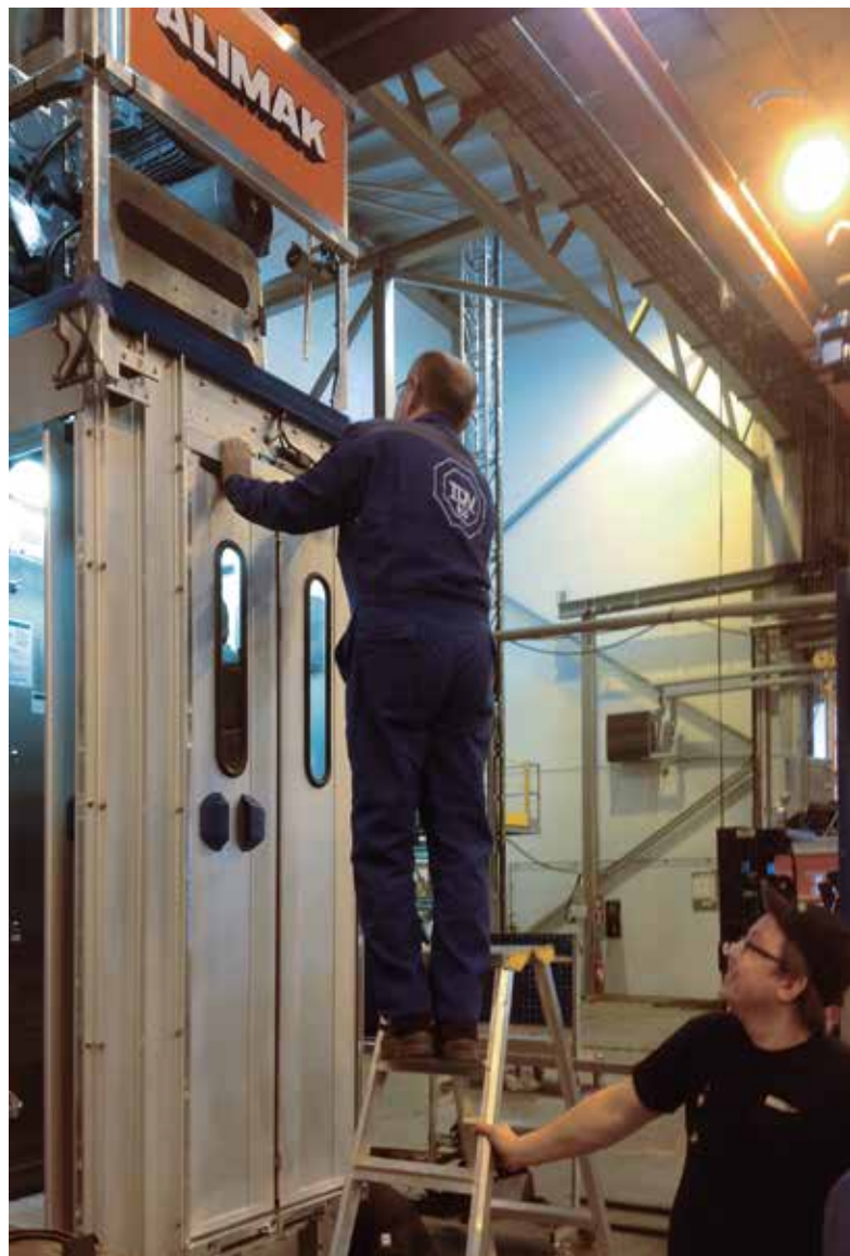
Sicherheitsschalter-Test durch den TÜV Süd.
